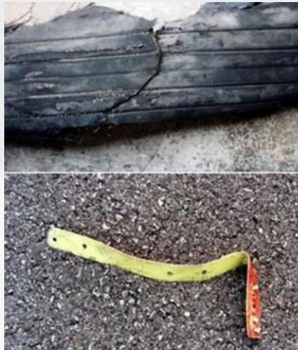
Esta pieza de titanio **perforó un neumático** permitiendo que trozos de caucho del neumático golpearán el depósito de combustible, además rompió un cable eléctrico.
