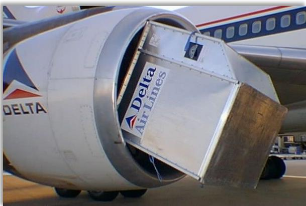
**2. En las calles de rodaje:** ya que otras aeronaves pueden ser dañadas por FOD (Objetos Residuales Extraños) y las aeronaves livianas se pueden volcar a causa de este fenómeno.
